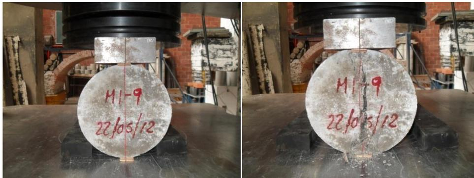
**Fig. 5.9** Configuración de la prueba para obtener la resistencia a tensión por compresión diametral (prueba brasileña), espécimen correspondiente a la mezcla de CRFA con un consumo de fibra de 40 kg/m<sup>3</sup>
