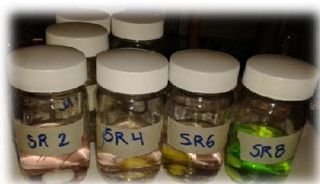
Figura 31: Lavado películas después de ser irradiadas.
