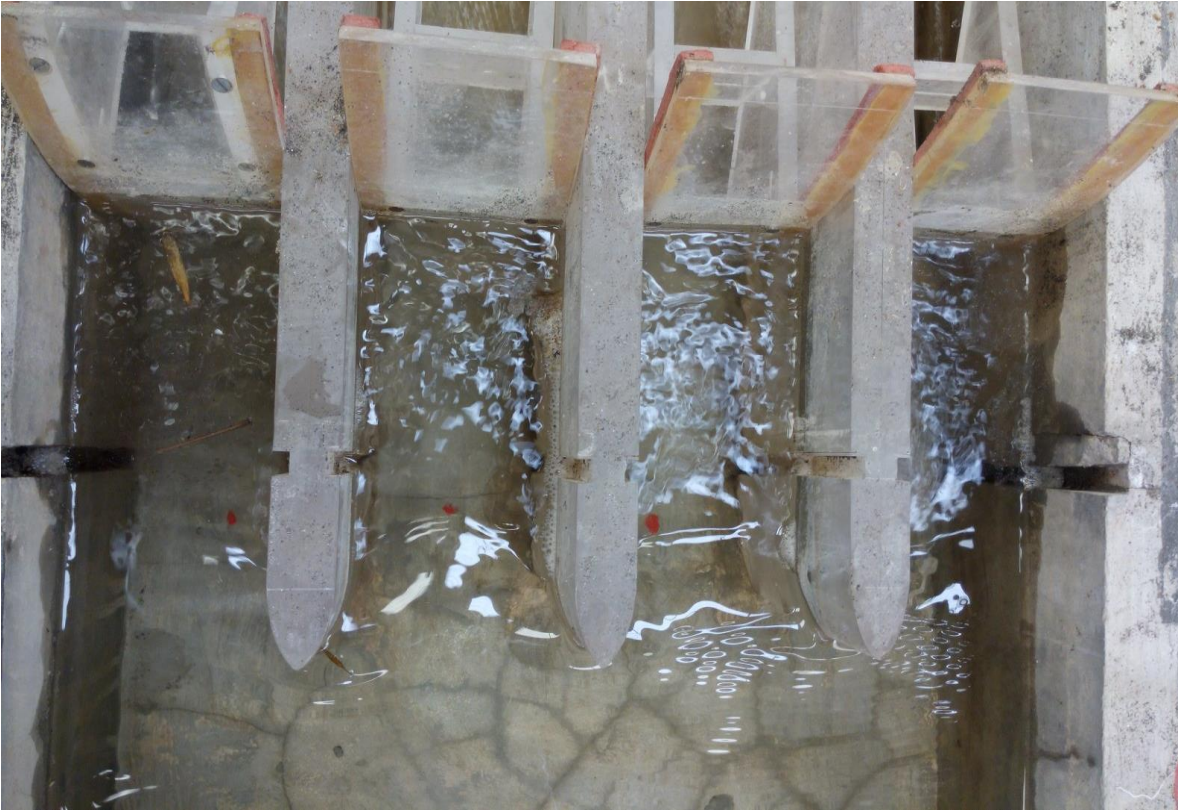
Figura 3.7 Ondas estacionarias generadas por la operación de compuertas y la presencia de pilas
