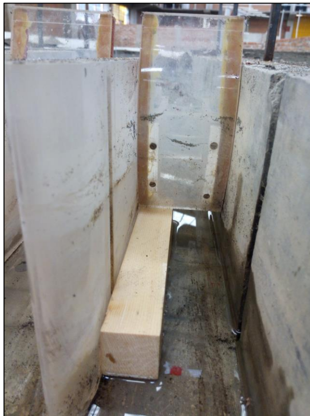
Figura 3.9 Determinación de la abertura de compuertas en el modelo físico
