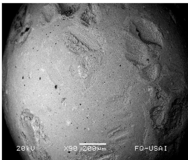
**Figura 4.9. Micrografía de un pellet de la tercera cama catalítica después de reacción.**
