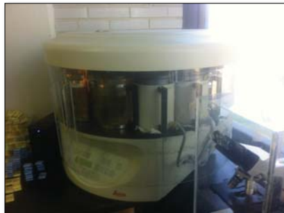
Figura 17. Procesador de tejidos (Histokinette Leica), para procesamiento de los segmentos de ligamento.
