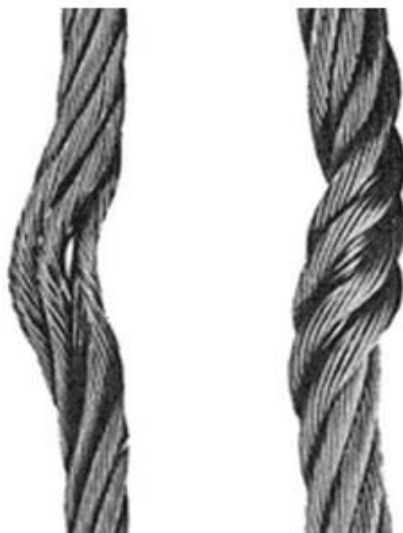
Figura. 6.8 “Cocas” en cable, debidas a manejo inadecuado.
