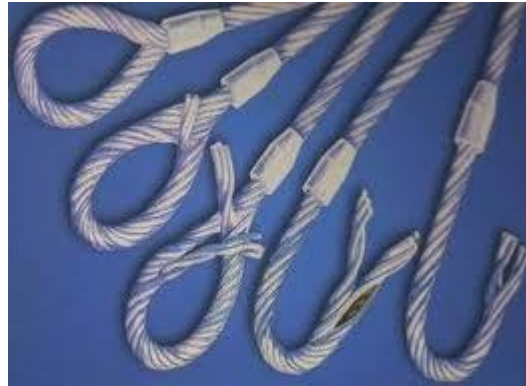
Fig. 9.12 Estrobo en proceso de encasquillarse
