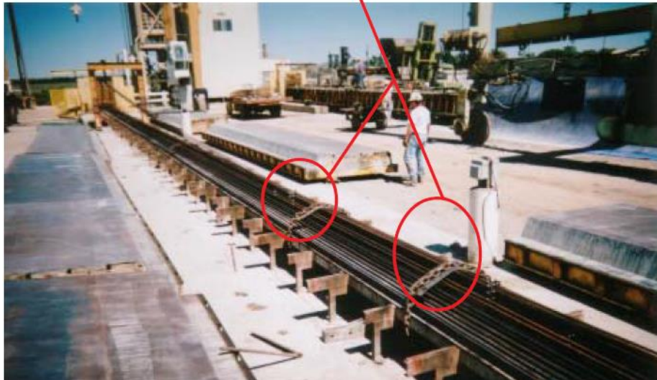
Figura 3.d Dispositivos de seguridad adicionales en el proceso
