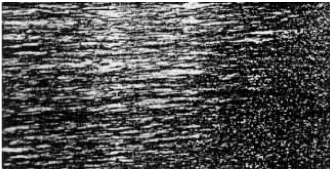
Figura 4.8 Microfotografía tomada a 150X de magnificación. Note la transición de la estructura fibrosa fría del lado izquierdo a una estructura granular afectada por calor en el lado derecho. Fuente: Journal of the Precast/Prestressed Concrete Institute, V. 35, No. 6, November-December 1990
