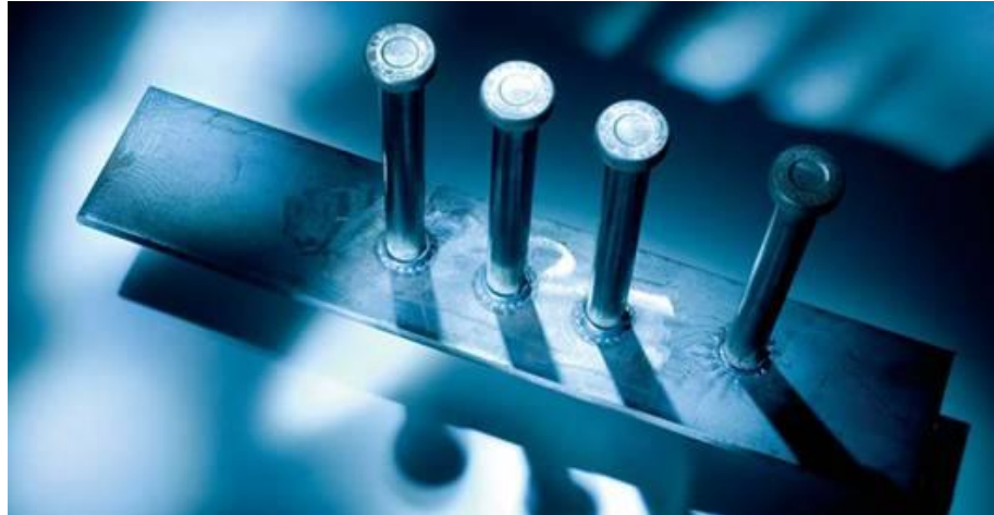
Fig. 8.5. Accesorio a base de soldadura de vástagos
