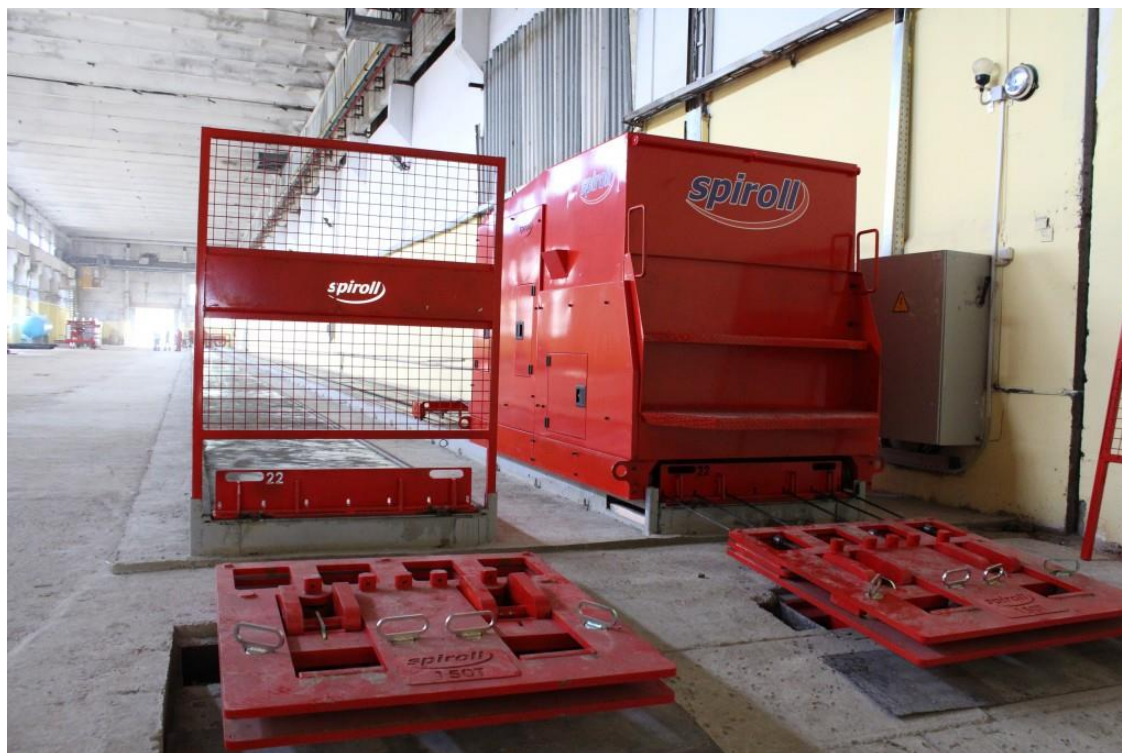
Figura. 6.4 Escudo para protección de los trabajadores.
