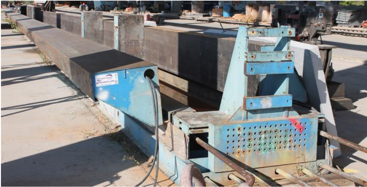
Figura 2.5 Molde autotensable para viga “T” invertida
