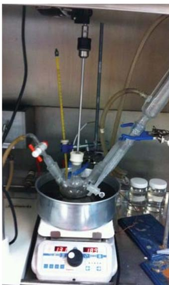
Figura 14. PGS. En esta imagen se muestra un matraz redondo de tres bocas con un condensador Liebig adaptado y una trampa Dean Stark con llave, en otra entrada tenemos el gas de nitrógeno de alta pureza y por último tenemos el agitador mecánico y un termómetro para registrar la temperatura a 120 °C en un intervalo de tiempo de 48 h.
