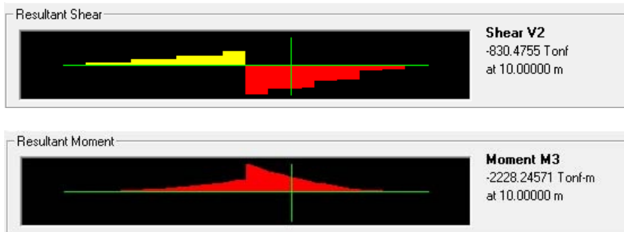
Figura 4.2 Diagramas de fuerza cortante y momento flexionante
