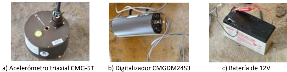
Figura 2.4 Equipo utilizado para medir vibración ambiental (Gómez et al., 2014)
