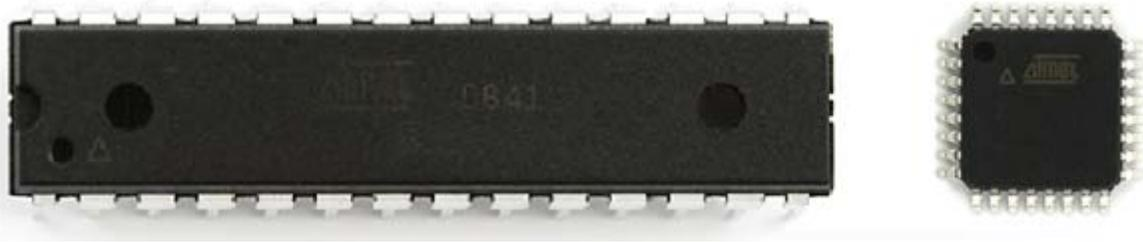
Figura 3.2. AVR, empaquetado DIP (izquierda) y TQFP (derecha).
