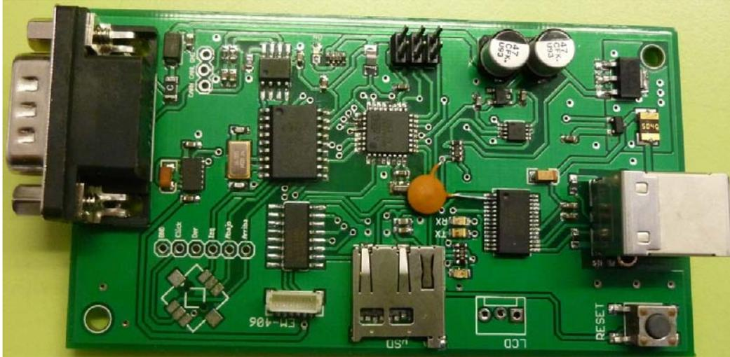
Figura 4.14. Integración completa de los componentes del UNAM-CAN.
