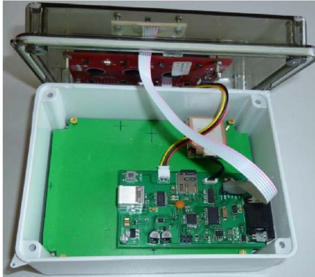
**Figura 4.52.** Montaje de la tarjeta en el gabinete.
