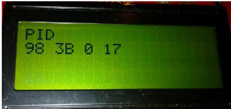
**Figura 4.39.** Parámetros soportados por el vehículo Diesel.
