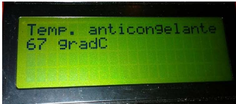
**Figura 4.43.** Temperatura del anticongelante del vehículo Diesel.
