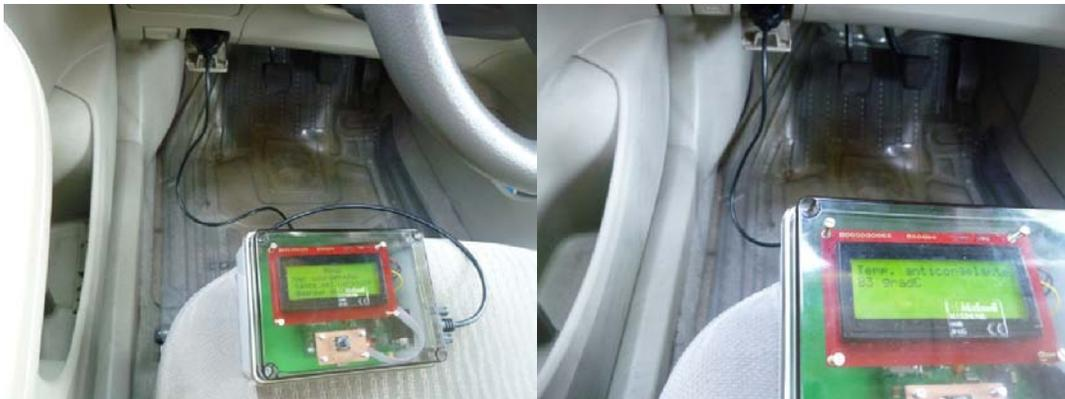
**Figura 4.55.** UNAM-CAN conectado a un vehículo.
