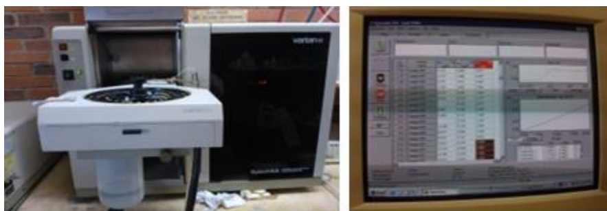
Figura 9. Espectrofotómetro de absorción atómica, con horno de grafito (Varian SpectrAA 220).
