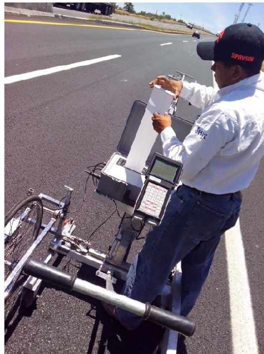
Fotografía 6.2 Impresión del Perfil Longitudinal terminada la prueba de Índice de Perfil.
