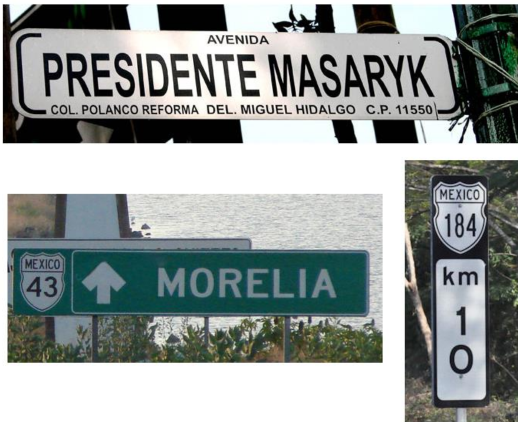
Imagen 5.7 Ejemplos de Señales de Identificación (Imagen superior: Nomenclatura, Imagen inferior izquierda: De Ruta, Imagen inferior derecha: De Kilometraje). 9
