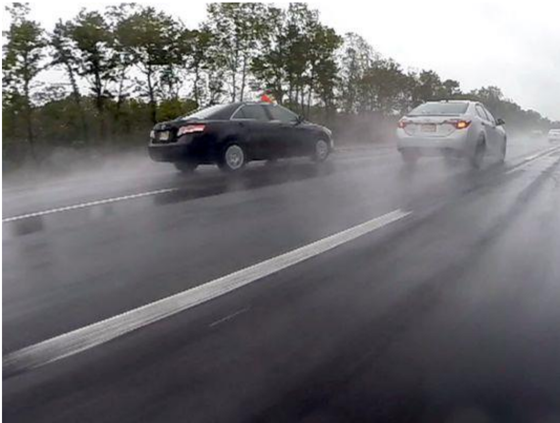
Imagen 2.8 Reducción del efecto Spray Back en carpetas Open Graded.
