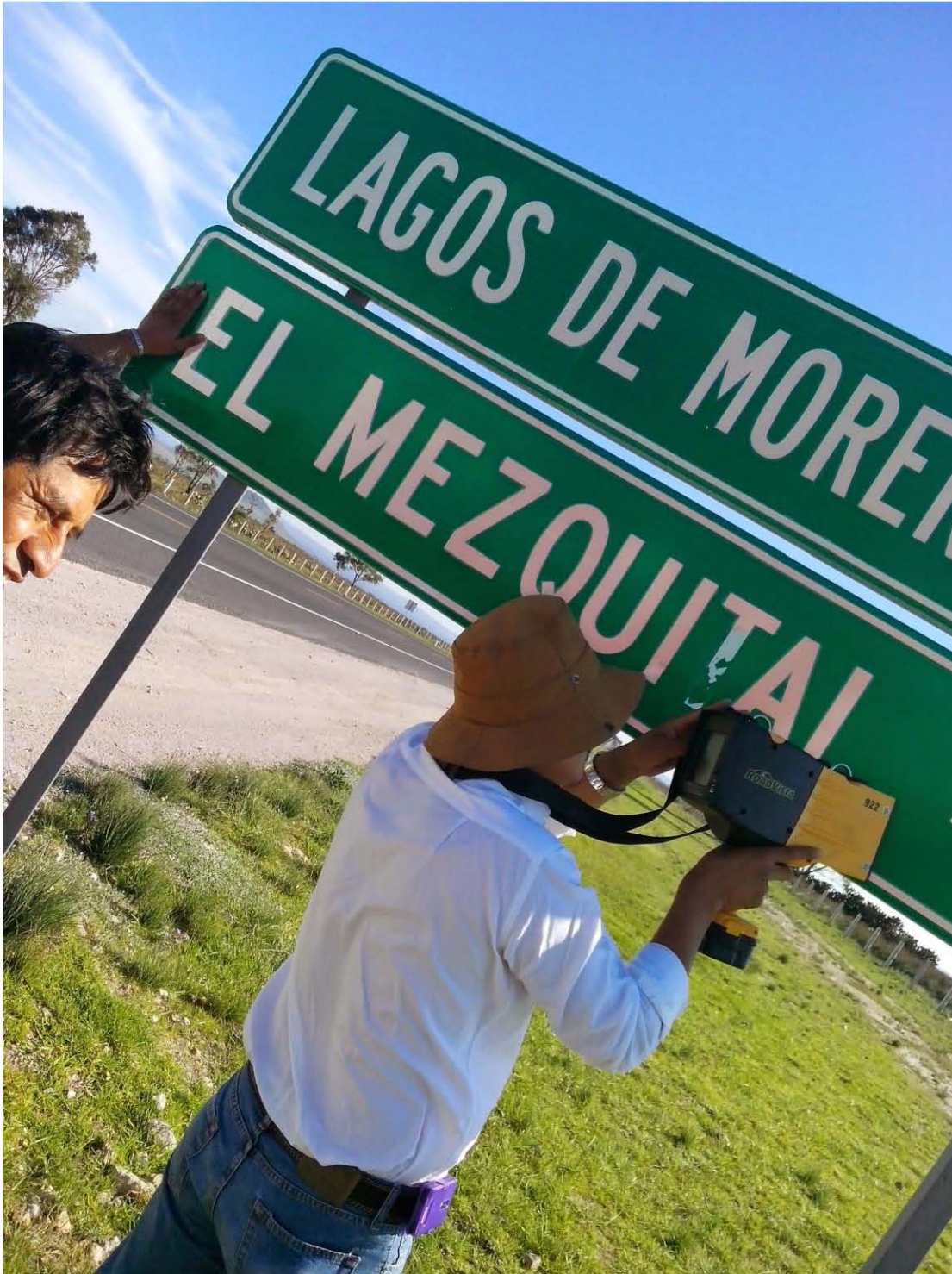
Fotografía 6.11 Medición de la Retroreflexión en el Señalamiento Vertical.
