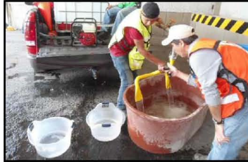
Figura 4 Equipo durante el proceso de verificación del gasto proporcionado por el equipo a la velocidad de operación.
