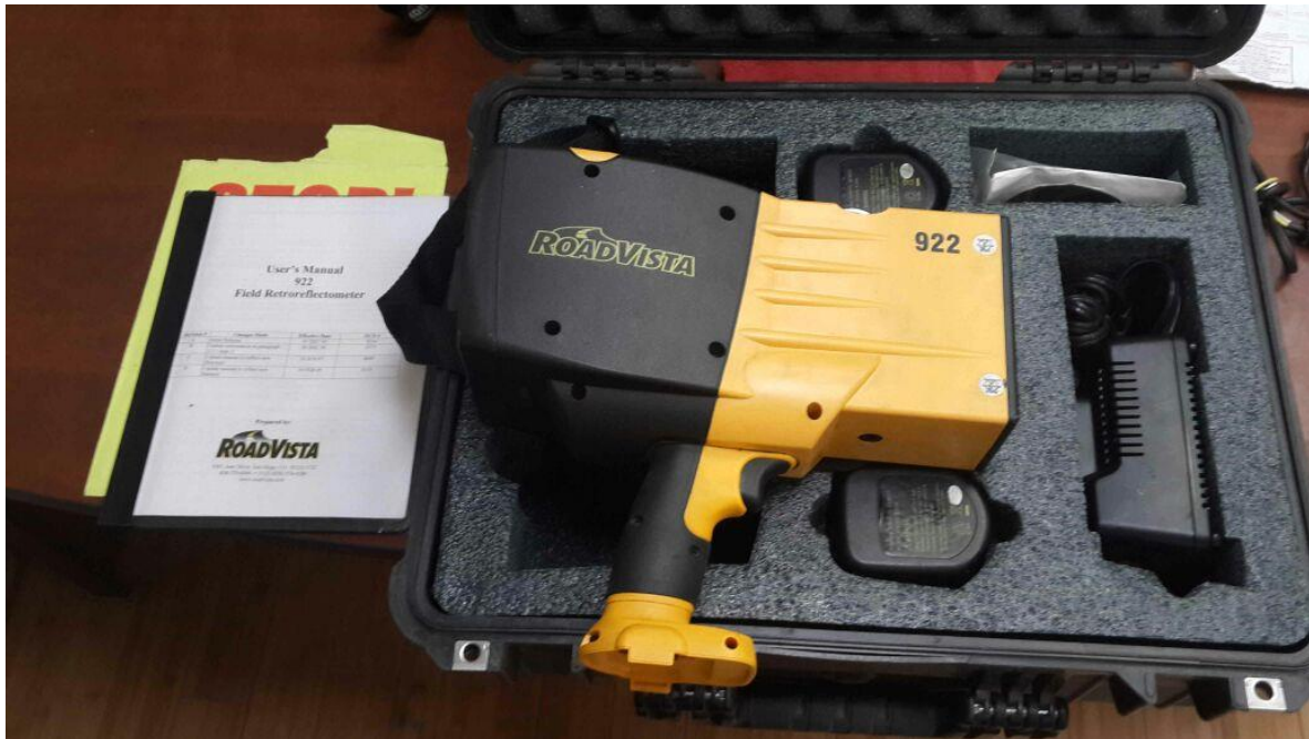
Fotografía 5.24 Equipo Reflectómetro para Medir el Coeficiente de Reflexión del Señalamiento Vertical.
