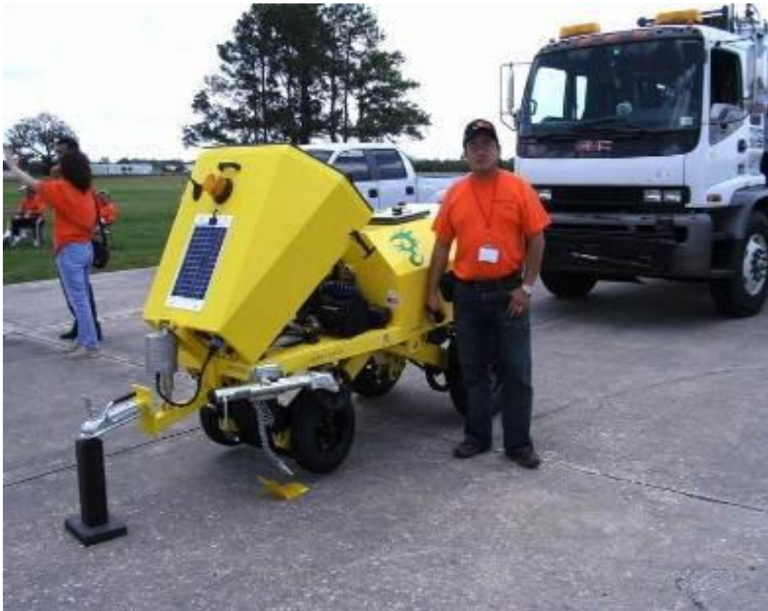
Fotografía 4.11 Equipo DFT utilizado para determinar el CF.
