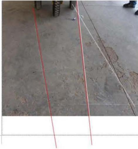
Figura 5 Trazo de la proyección de las ruedas en posición de medición de la fricción
