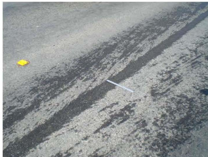
Figura 3 Determinación del ancho de franja mojada para la determinación del gasto por unidad de ancho.
