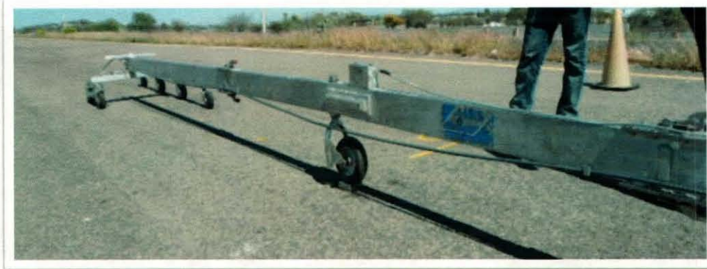
Ilustración 3.1 Procedimiento de calibración del perfilógrafo en la escala vertical.
