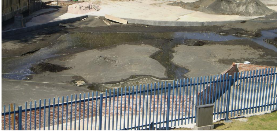
Figura 1.2 Modelo físico de los ríos Mezcalapa, Carrizal y Samaria en el Instituto de Ingeniería
