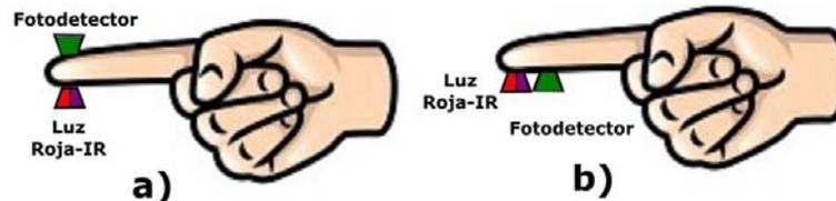
FIGURA 1.5 TIPOS DE CONFIGURACIÓN DE UN OXÍMETRO, A) POR TRANSMISIÓN, B) POR REFLEXIÓN.
