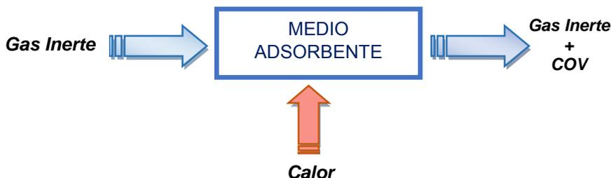
Figura 14. Proceso de desorción mediante el paso de un gas inerte por la columna (Elaboración propia).
