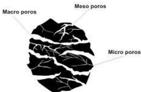
Figura 7. Representación esquemática de los poros del carbón activado (Apelsa, 2004).
