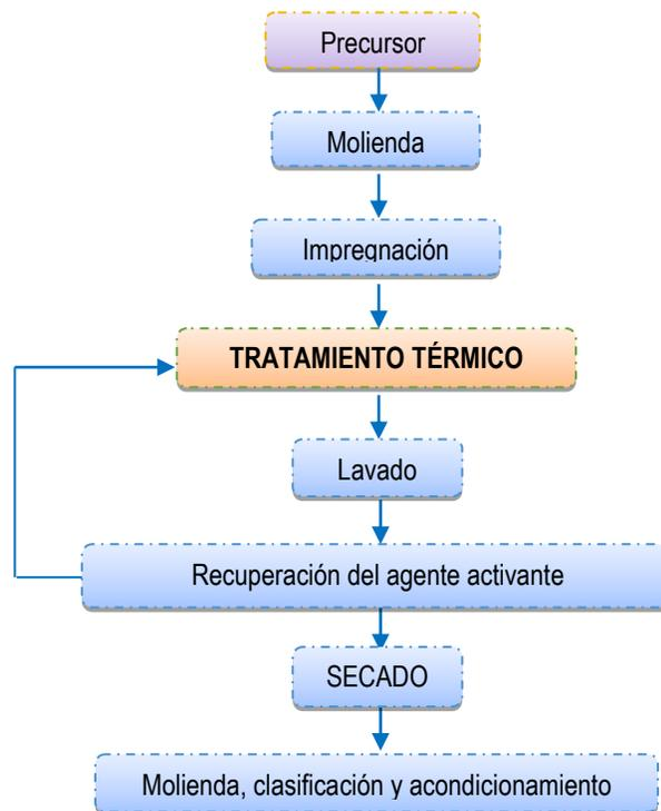
Figura 10. Diagrama de la activación química del C.A. (Elaboración propia)
