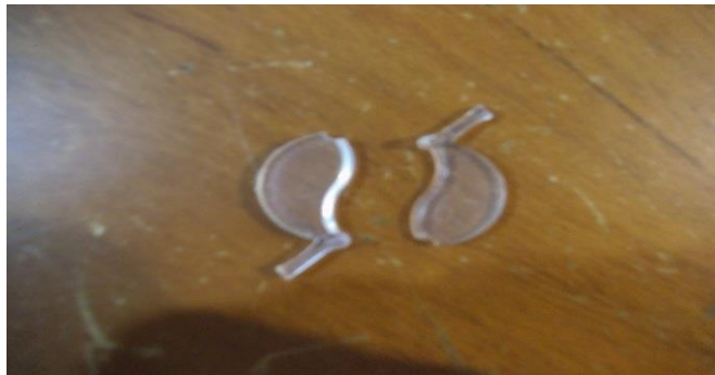
Figura 1.7: Piezas Inyectadas en PLA de las paletas
