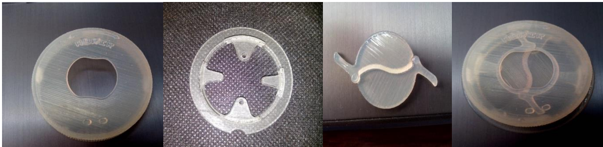
Figura 3.13: Segunda serie de prototipos, actuador, base, paletas y ensamble respectivamente
