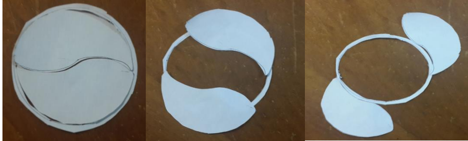
Figura 4.9: Paletas que salen del actuador, cerrado (izquierda), semi abierto (centro) y abierto (derecha)
