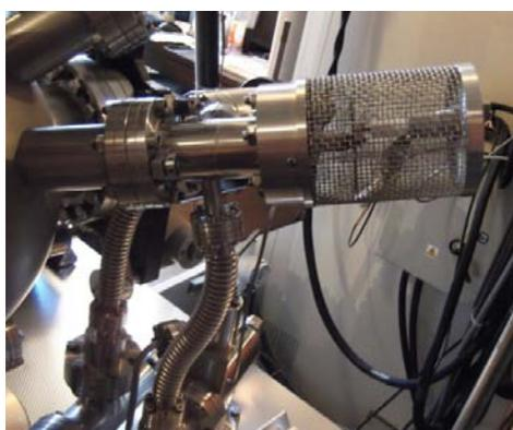
Figura 2.13: Fuente de rayos UV utilizada para el estudio de UPS.
