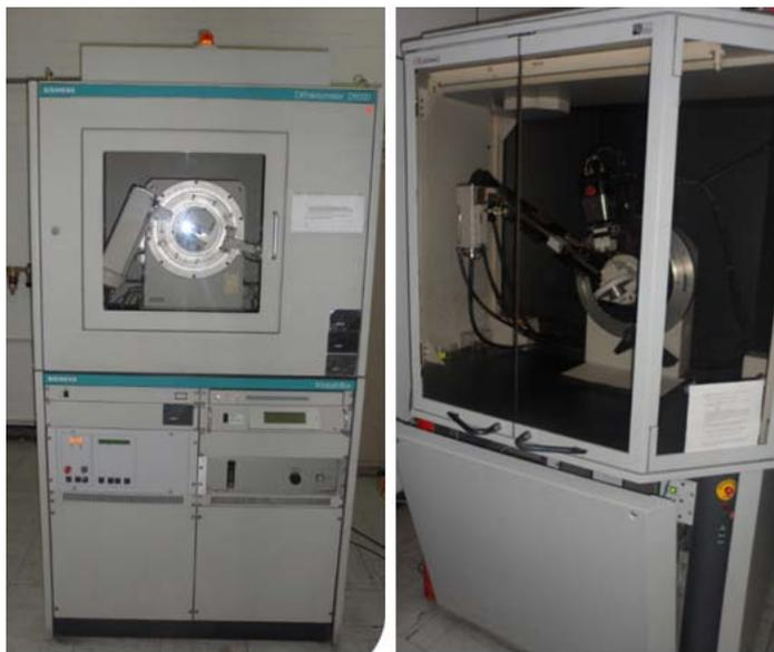
Figura 2.2: Difractómetros de rayos X: D5000 izquierda y D8 derecha.
