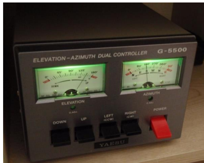
Figura 5-19 Control del rotor en azimut y elevación 24
