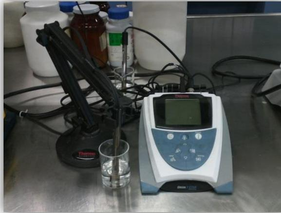
**Figura 4.1.5 Potenciómetro pH (medidor de pH)**
