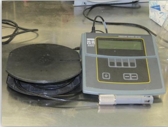
**Figura 4.1.6 Medidor de Oxígeno Disuelto**
