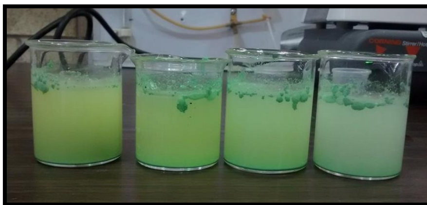
Figura 6.6. Pruebas a pH=8 y pH=9 con el efecto del agente de sulfuración ( \text{Na}_2\text{S}\cdot 9\text{H}_2\text{O} ) ( 1.0 \times 10^{-3} \text{ M} )
