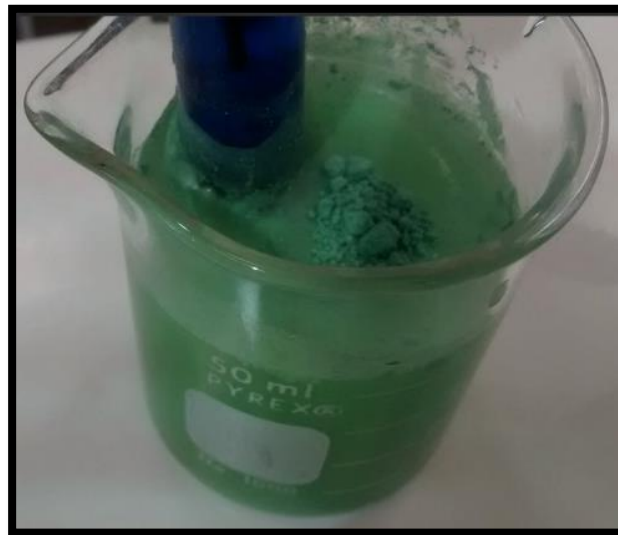
Figura 6.9. Ajuste de \text{pH} = 7 en presencia de XIP ( 1.5 \times 10^{-3} M) + \text{Na}_2\text{S} \cdot 9\text{H}_2\text{O} ( 2.0 \times 10^{-3} M)
