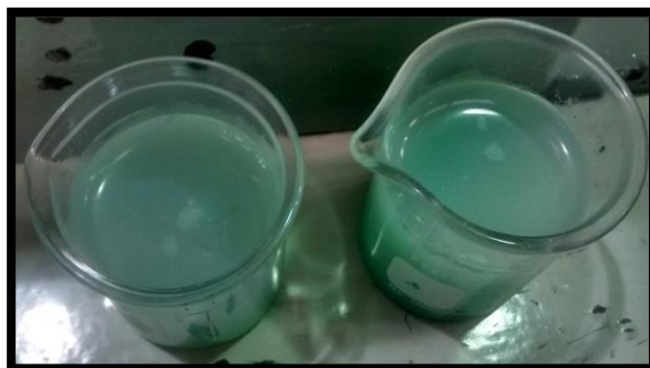
Figura 6.6. Pruebas a pH=8 y pH=9 con el efecto del agente de sulfuración ( \text{Na}_2\text{S}\cdot 9\text{H}_2\text{O} ) ( 1.0 \times 10^{-3} \text{ M} )
