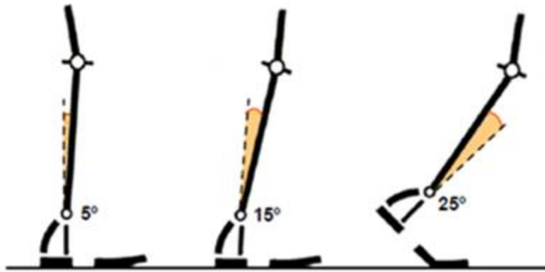
Figura 1.9 Estudio cinemático del tobillo en el intervalo 2 de la marcha (Luna, 1993)
