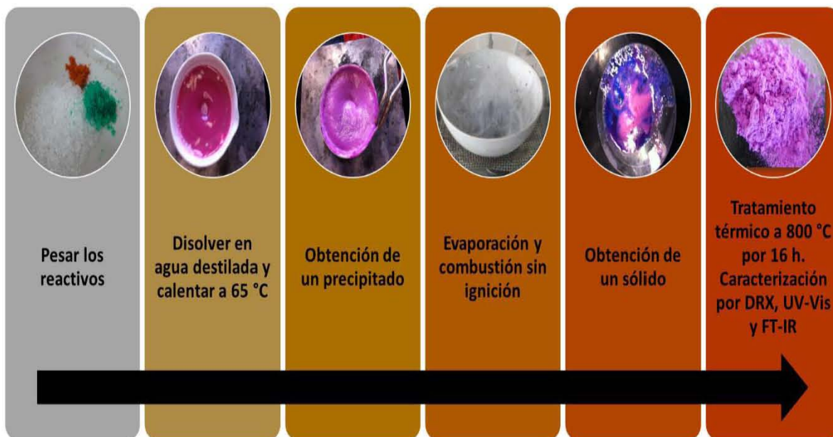
Diagrama 2. Procedimiento experimental de síntesis de los fosfolivinos \text{LiMPO}_4 ( M=\text{Co}^{2+} , \text{Ni}^{2+} ) y \text{LiNi}_x\text{Co}_{1-x}\text{PO}_4 , ( X=0.1 a 0.9 )
