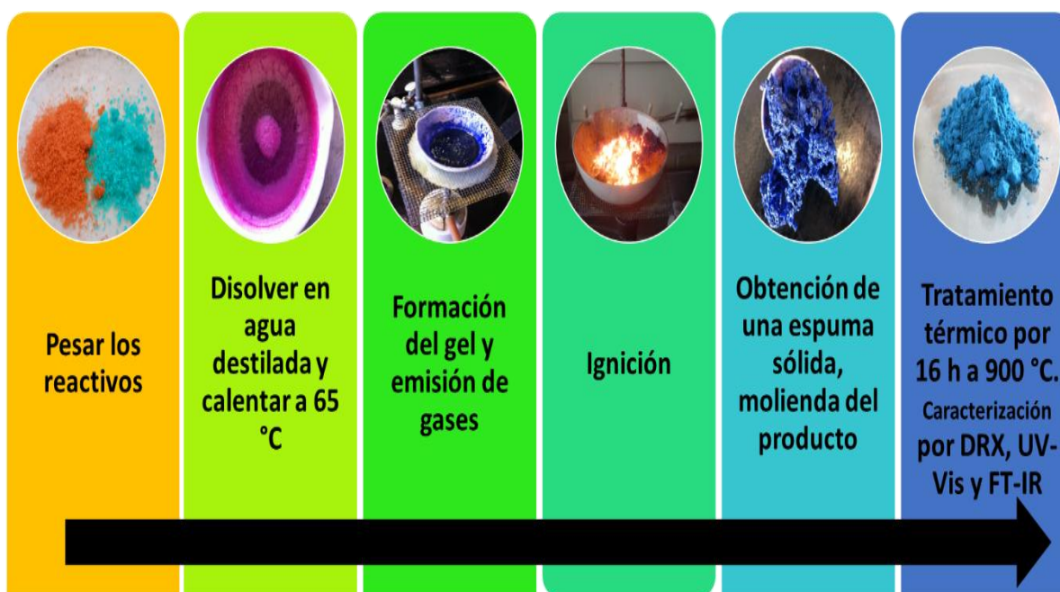
Diagrama 1. Procedimiento experimental de síntesis de las espinelas \text{MAl}_2\text{O}_4 ( \text{M}=\text{Co}^{2+} , \text{Ni}^{2+} ) y \text{Ni}_x\text{Co}_{1-x}\text{Al}_2\text{O}_4 , ( X=0.1 a 0.9 )
