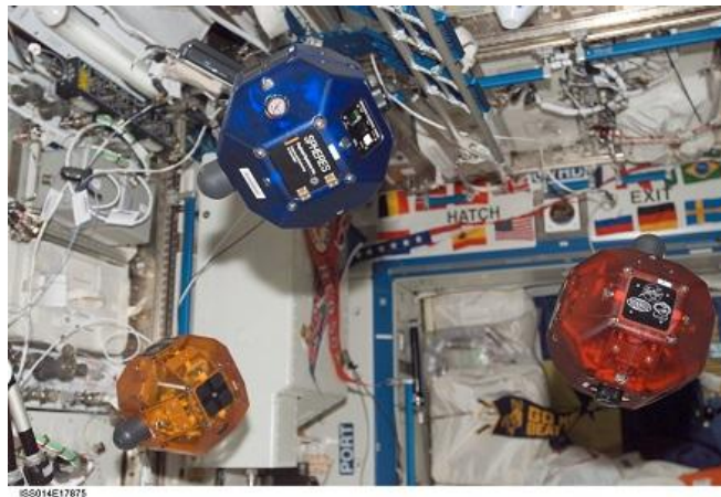
Figura 2-5 Tres SPHERES en pruebas de maniobras de formación [15]
