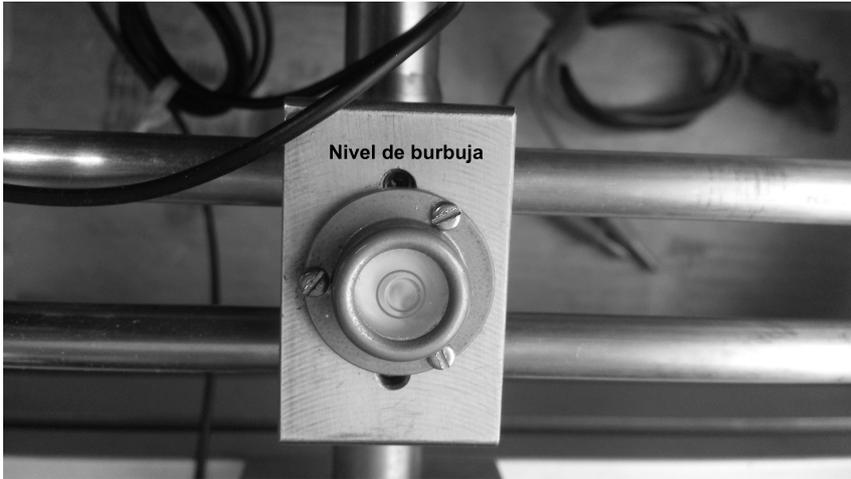
Figura 33 Nivel de burbuja utilizado para verificar el balanceo del equipo
