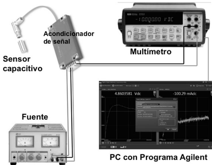
Figura 44 Diagrama de Conexiones del Sensor de Profundidad
