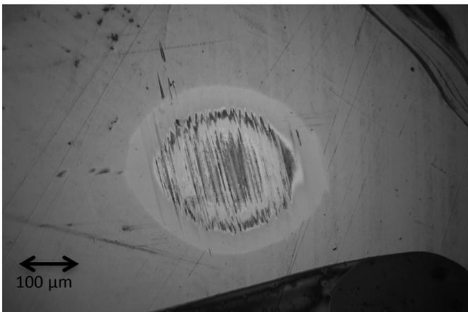
Figura 54 Huella obtenida en TiN sobre acero 304 utilizando 1N de carga
