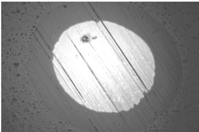
Figura 63 Huella obtenida en TiBCN sobre acero 304 utilizando 1N de carga
