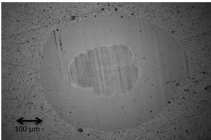
Figura 59 Huella obtenida en TiVN sobre acero 304 utilizando 2N de carga
