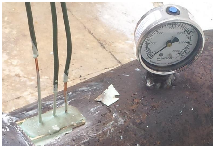
Fig. 20 Disposición electrodos y manómetro.
