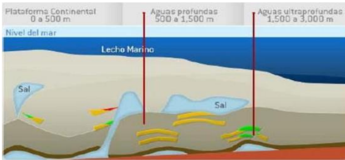
Fig. 1 Clasificación de aguas profundas [1]
