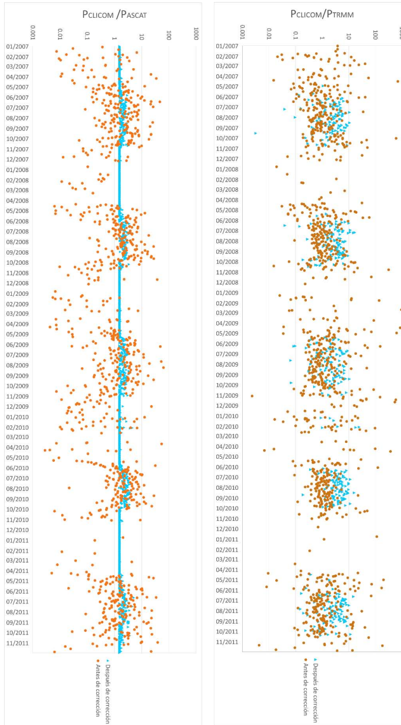
Figura 4. 27. Series de tiempo corregidas respecto a P_{CLICOM} para TRMM (derecha) y ASCAT (izquierda) para estaciones con altitudes mayores a 1,000 msnm
