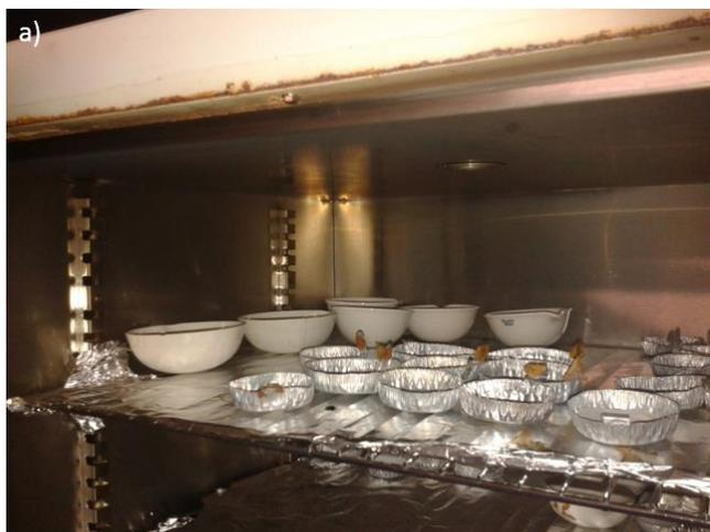
**Figura 2.4. Charolas en estufa de convección para determinación de humedad.**
