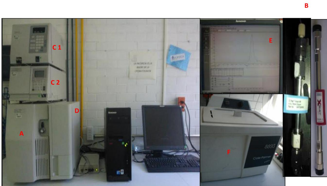
Figuras 3.3. Sistema cromatográfico empleado: (A) bomba bimodal, (B) columnas cromatográficas, (C1) detector de conductividad, (C2) detector UV-visible, (D) transductor, (E) software, (F) desgasificador ultrasónico.
