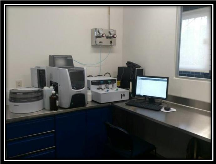
**Fig. 19. Equipo de determinación de carbono orgánico total TOC-LCSH/CPH**
