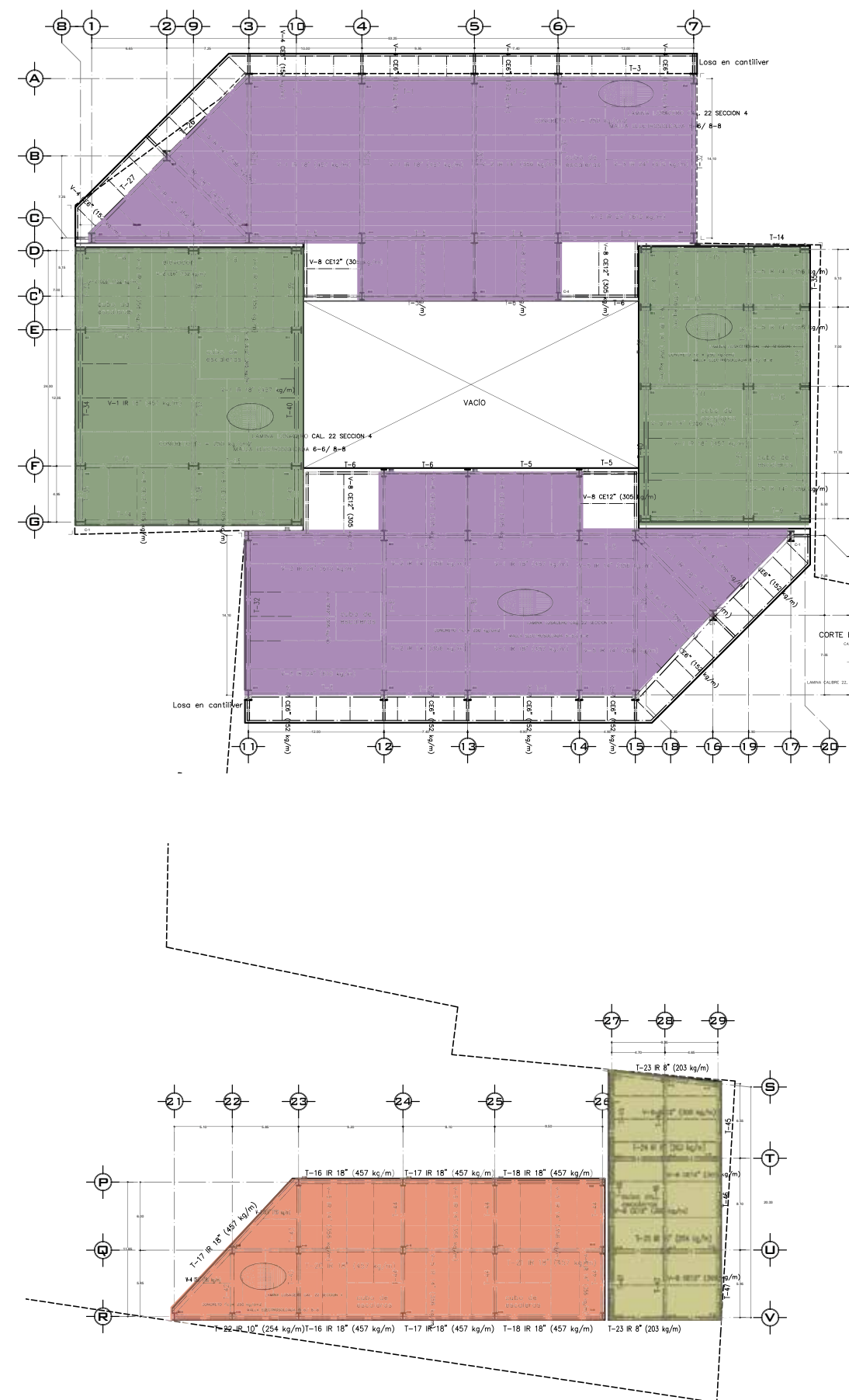
Imagen 2.2.25.- Plantas esquemáticas que muestran las juntas constructivas en ambos edificios, para ver a detalle los planos estructurales, ver el apéndice- anteproyecto - planos estructurales.
