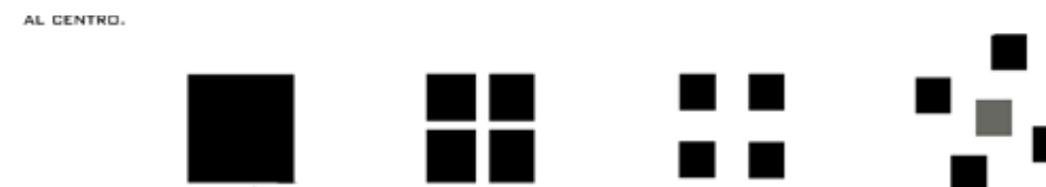
Imagen 1.2.12- Esquema que muestra la organización de los conjuntos de vivienda que parte de la separación de un cuadrado y se distribuyen las divisiones de forma que se ordenan de modo que continúan siendo un total.
