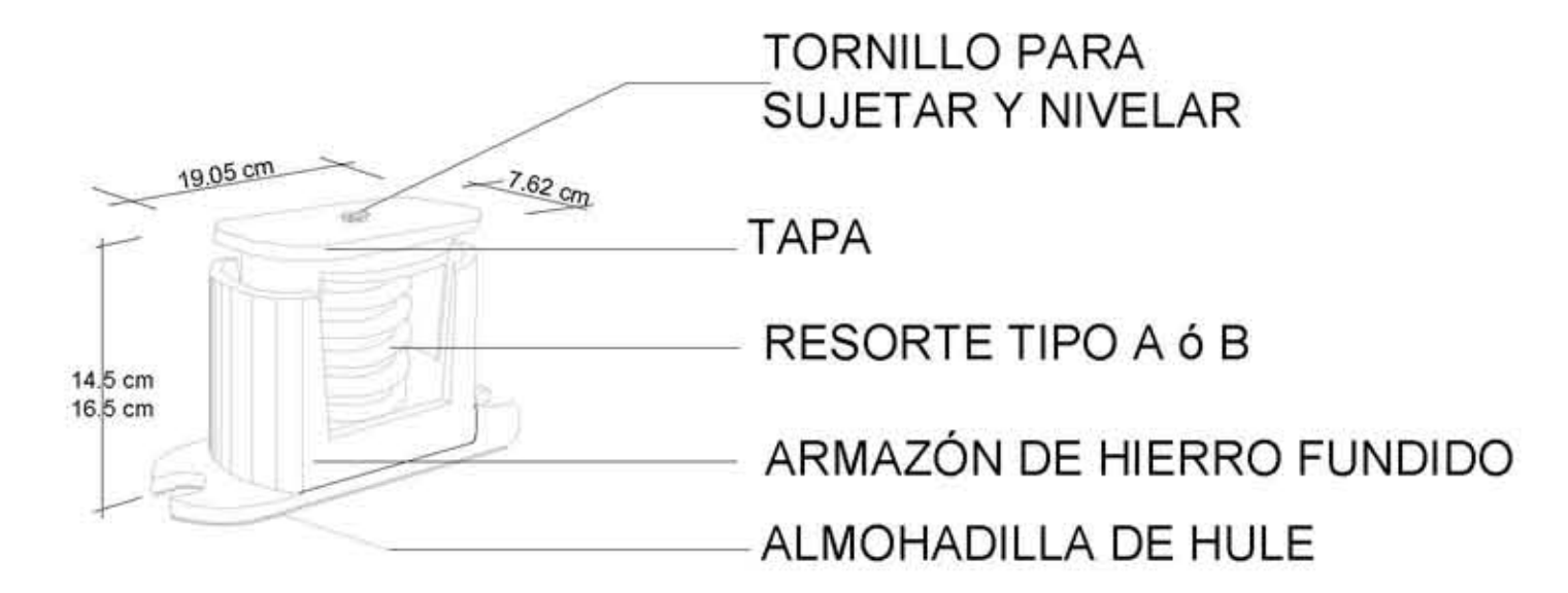
SISTEMA DE SOPORTES MARCA RSA CONTRA VIBRACION
