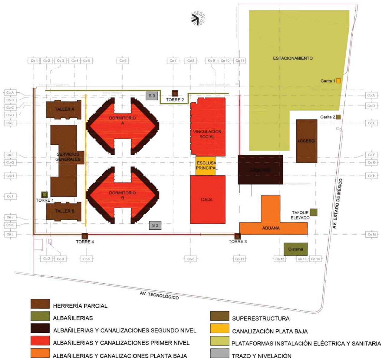
Plano de frentes de obra ejecutándose
