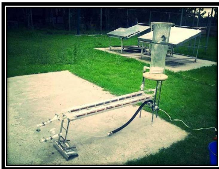
Figura 27. Reactor fotocatalítico solar tipo CPC
