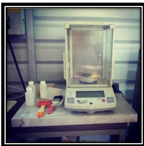
**Figura 23. Balanza analítica Ohaus<sup>®</sup>**
