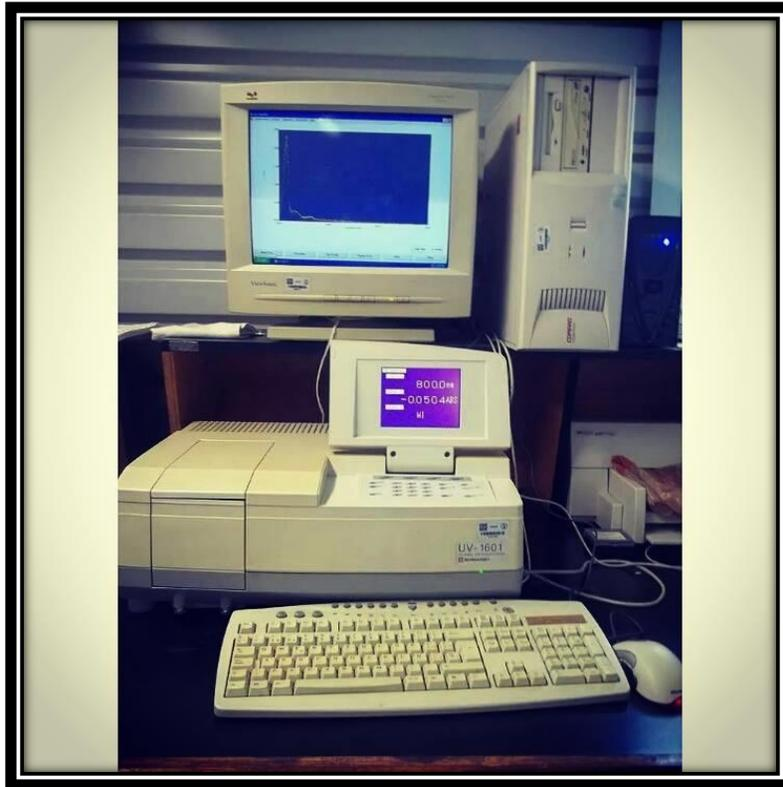
**Figura 24. Espectrofotómetro UV-Visible (Shimadzu UV 1601)**
