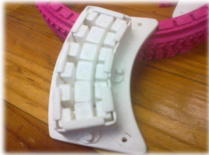
Figura 4.21 Tapa tipo caliper con ferritas.
