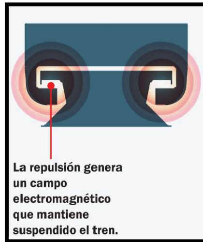
Figura 2.3 Principio de funcionamiento
