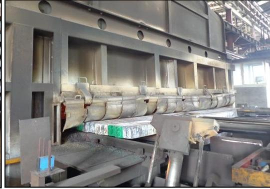
Fig. 2.6 Introducción de palanquillas al Horno.
