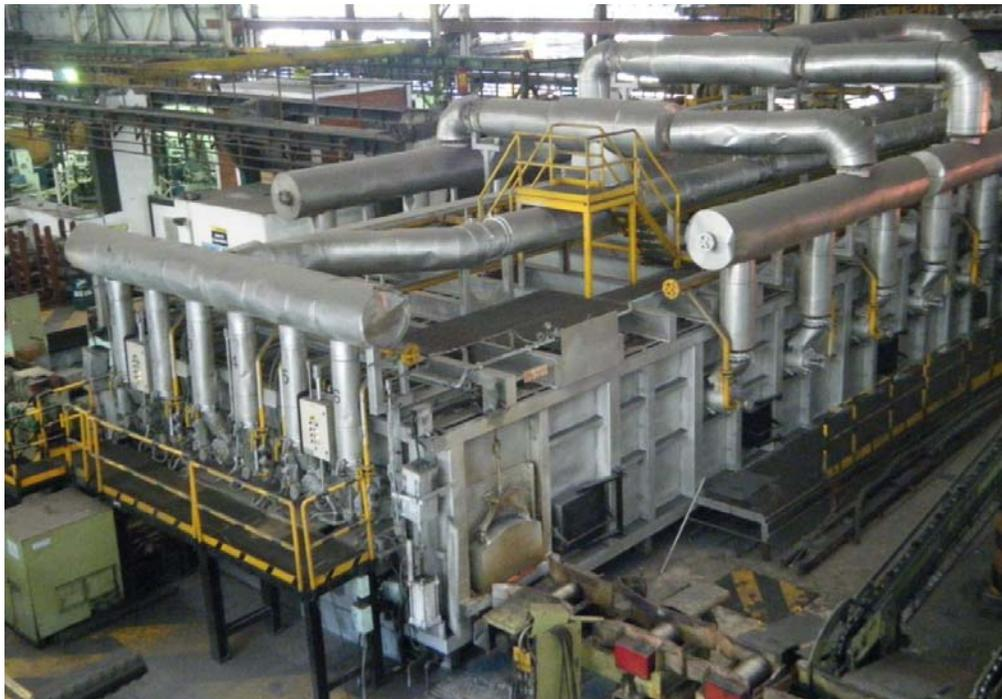
Fig. 2.1 Horno de recalentamiento de una planta productora de la Cd. de México.
