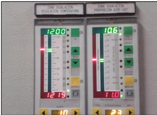
Fig. 2.7 Control de temperatura y Relación Aire/Gas.
