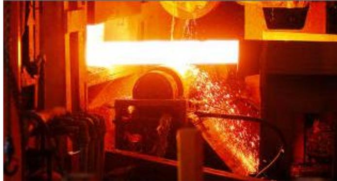
Fig. 1.19 Deshornado lateral de un horno convencional.
