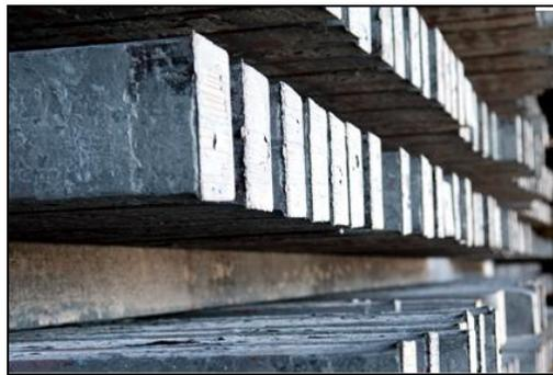
Fig. 1.32 Área transversal de palanquillas antes de recalentar [14].
