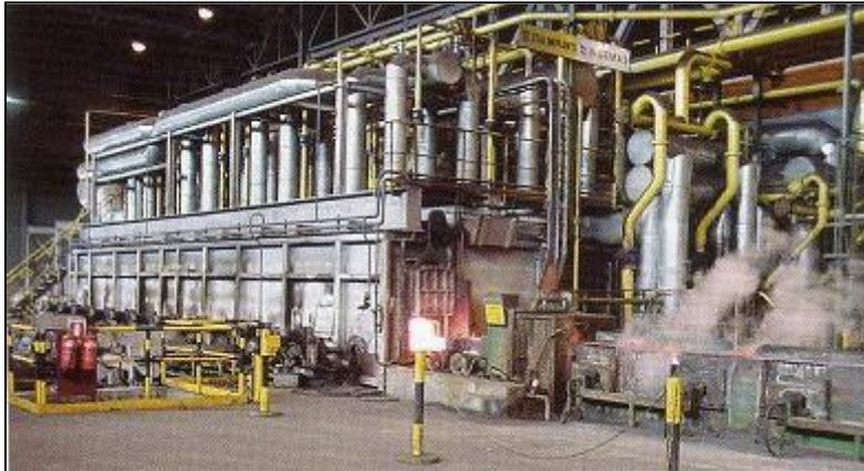
Fig. 1.12 Horno de recalentamiento de una unidad siderúrgica convencional.
