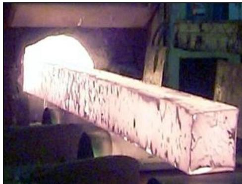
Fig. 1.33 Area transversal de palanquilla despues de recalentar.
