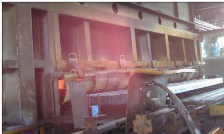
Fig. 1.13 Carga frontal en frío de un horno de recalentamiento.
