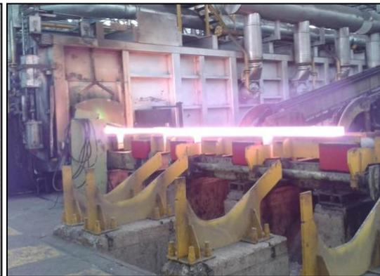
Fig. 2.8 Salida de palanquillas del horno.
