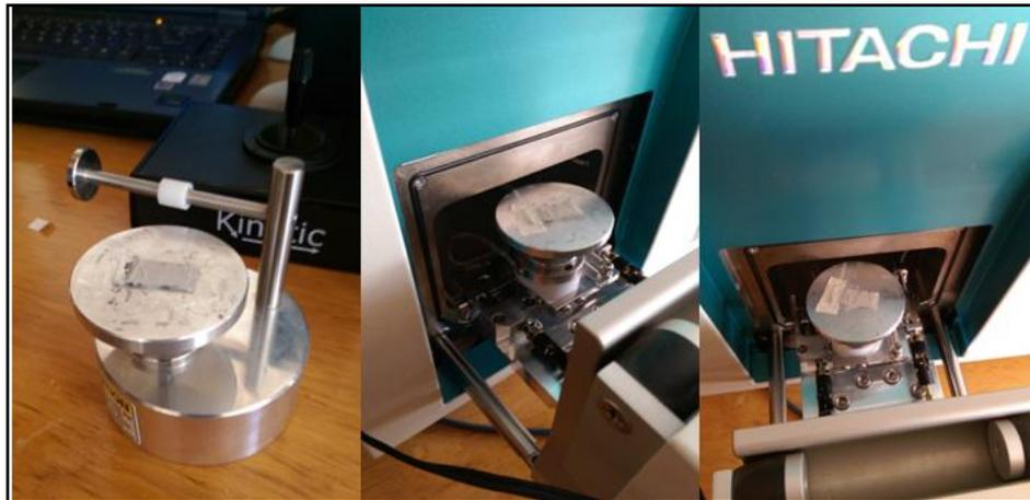
*Figura 5. 8. Colocación de muestra en la platina*
