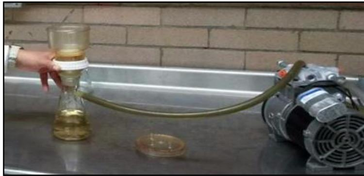
*Figura 5.18 Matraz kitazato acoplado a una bomba de vacío*
