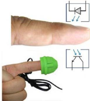
Figura 14. Sensores dentro del dedal; diodo y fototransistor.
