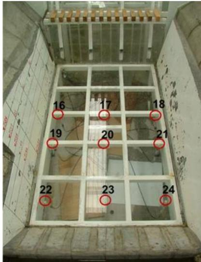
**Ilustración 3.56. Distribución de piezómetros en el tanque amortiguador.**
