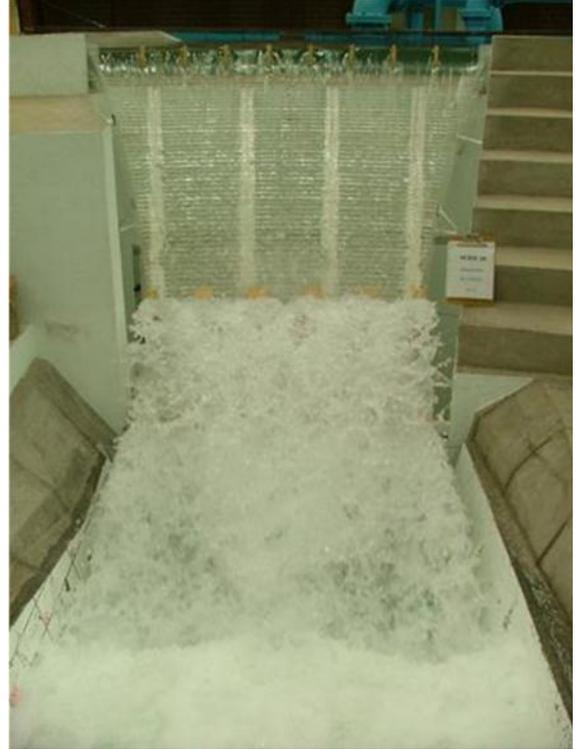
**Ilustración 3.53 Funcionamiento de la rápida y tanque amortiguador con gasto de diseño**
