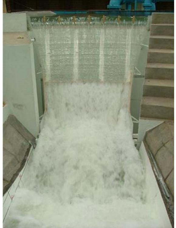
**Ilustración 3.45** Funcionamiento de la rápida y tanque amortiguador con gasto de diseño
