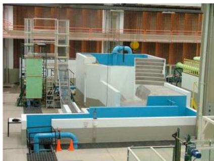
**Ilustración 3.16** Vista de modelo físico del vertedor de la presa el Zapotillo.
