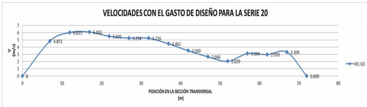
Ilustración 3.65 Gráfica de velocidades para el gasto de diseño 4,795 m<sup>3</sup>/s
