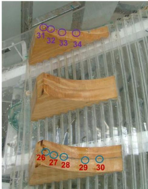
**Ilustración 3.60** Distribución de piezómetros en los deflectores ubicados en la rápida
