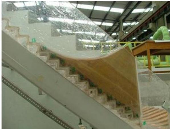
**Ilustración 3.30 Colocación de los deflectores sobre escalones de la rápida. Pieza 6\*.**
