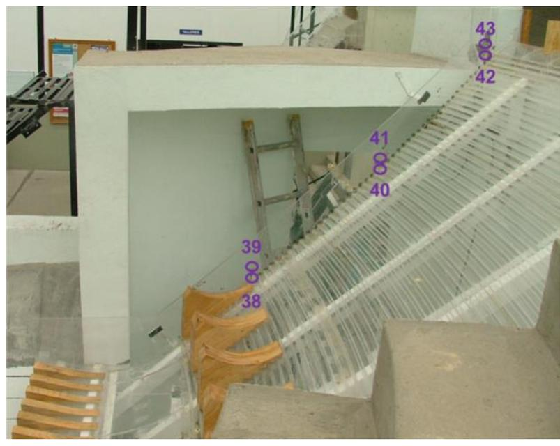
Ilustración 3.62 Distribución de piezómetros en el muro sobre la margen derecha.
