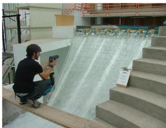
**Ilustración 3.41** Medición sobre la rápida
