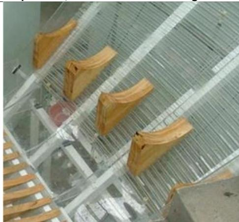
**Ilustración 3.29 Deflectores sobre escalones de la rápida, pieza 6\*.**
