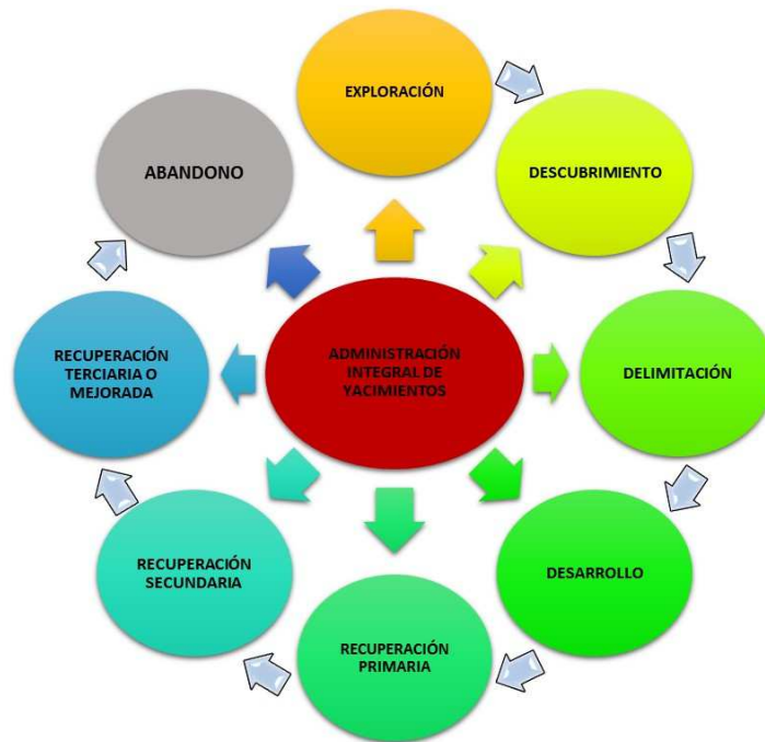
Figura 4: "La Administración Integral de Yacimientos en la Vida de un Proyecto Petrolero"
