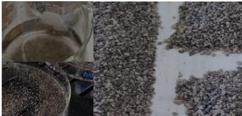
*Figura 6. Preparación de muestra para el conteo de puntos. Las fracciones seleccionadas se lavaron con agua destilada, posteriormente se sumergieron en un ultra sonido para desprender los fragmentos finos que pudiesen quedar adheridos a las superficie. Posteriormente se secaron las muestras en un horno a 60°C durante 24 h, posteriormente la muestra se cuarteo.*
