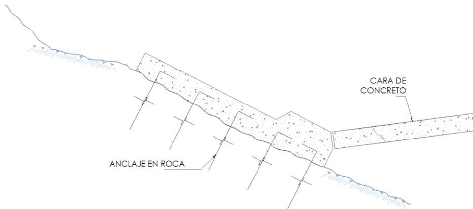
Figura 4-10 Plinto Inclinado (Machadinho)
