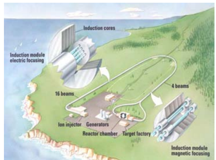
Figura 21. 36 Concepto de una planta de energía por fusión inercial basada en un acelerador de inducción de iones pesados.
