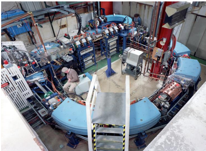
Figura12. 29 Centro de Tratamiento con protones en Loma Linda, California, E.U.A, utiliza un sincrotrón para acelerarlos e inyectarlos dentro del cuerpo del paciente. Se construyó en Fermilab para Loma Linda.
