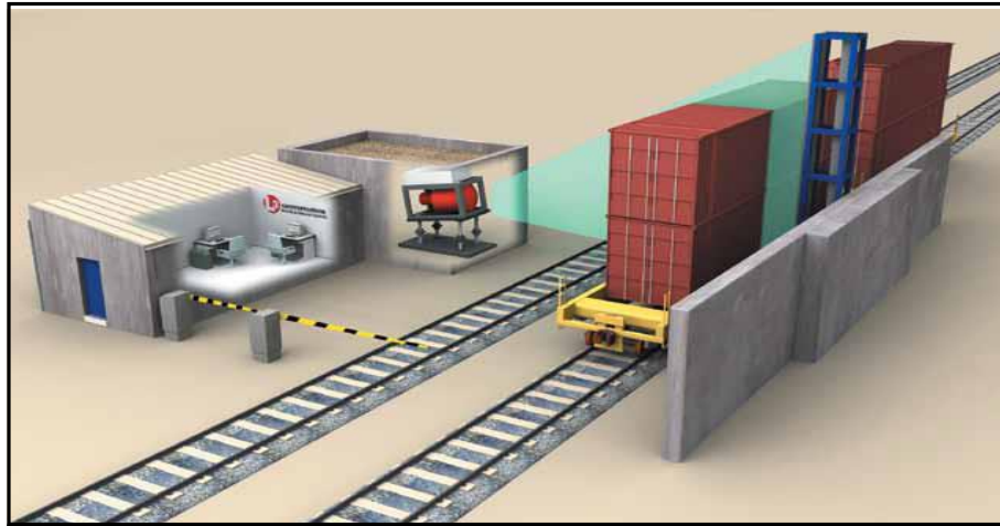
Figura 24. 39 Aplicación de rayos X generados en un acelerador para escanear contenedores y verificar el tipo de carga.
