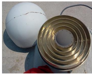
Figura 10. Antena AT504 (punto de referencia)
