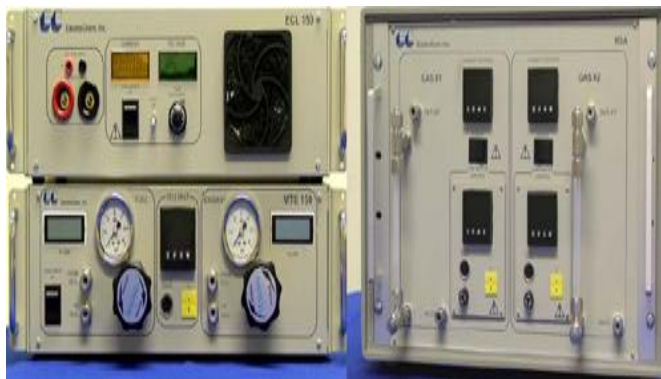
Figura 25. Módulo de prueba de celdas de combustible
