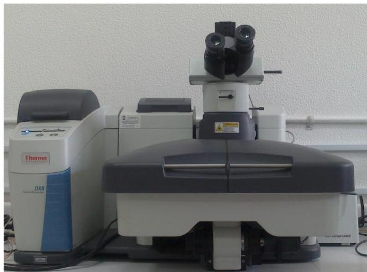
**Figura 14. Equipo para Espectroscopía Raman Thermo SCIENTIFIC DXR**
