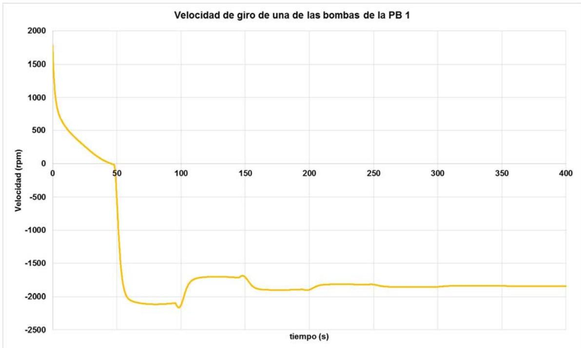
Fig. 37 Velocidad de giro de las bombas de la PB1 (sin cierre de válvula y sin dispositivos).
