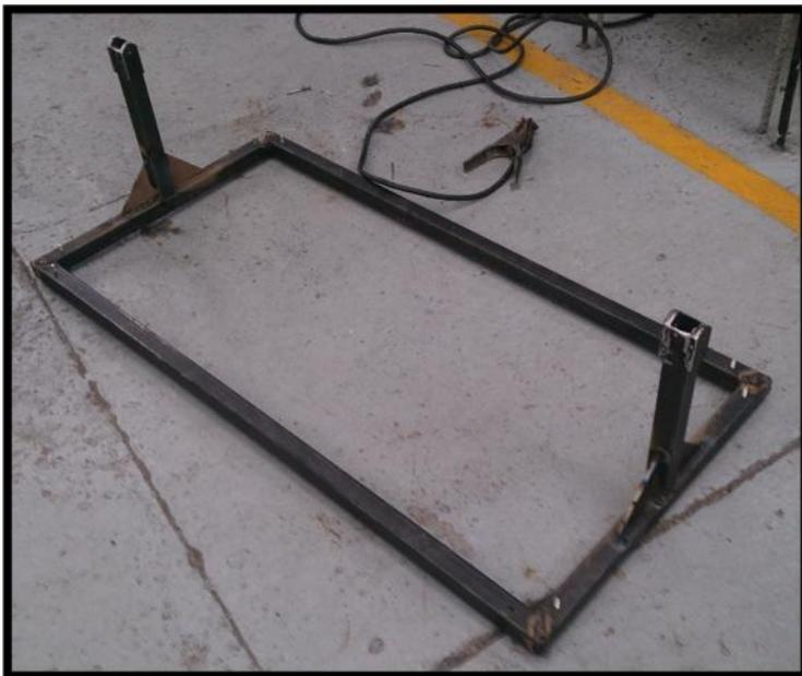
Posteriormente se sueldan los elementos que sostendrán el marco de ángulo en el punto medio de la base de ptr, para reforzar la estructura se colocan unos cartabones y se sueldan las placas que regularan la inclinación del panel procurando que los barrenos roscados de las mismas queden concéntricos con los del ptr.
