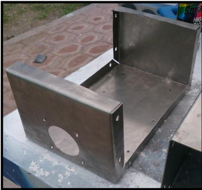
Para hacer el barreno del ventilador, primeramente se utilizó la broca para lámina de 1/4, después la de 1/2 , para hacer el diámetro más grande, se utilizaron unos ponchadores, los cuales estrangulan la lámina hasta cortarla
