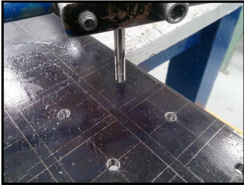
Figura 5.11 Barrenos roscados de 1/4".
