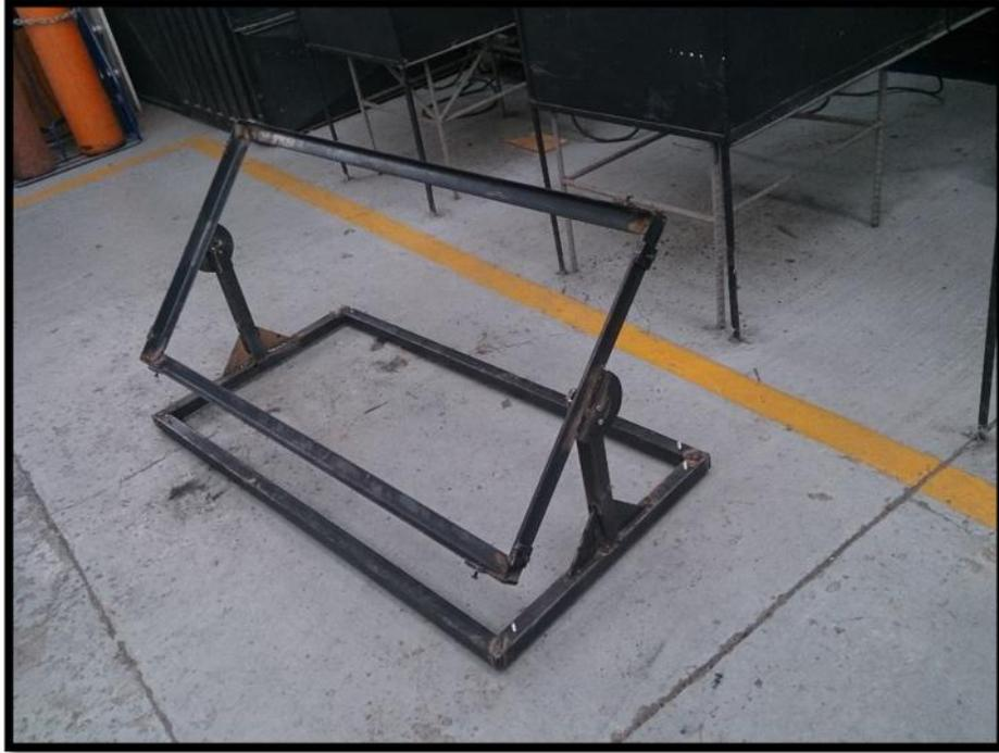
*Figura 5.12 Ensamble final de la base para el panel solar.*
