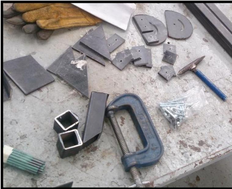
Utilizando la cortadora de disco y el arco con segueta se seccionaron las piezas de la placa de 1/4". Para un mejor acabado de las caras laterales se utilizó la fresadora y por último se mataron los filos con un esmeril.
