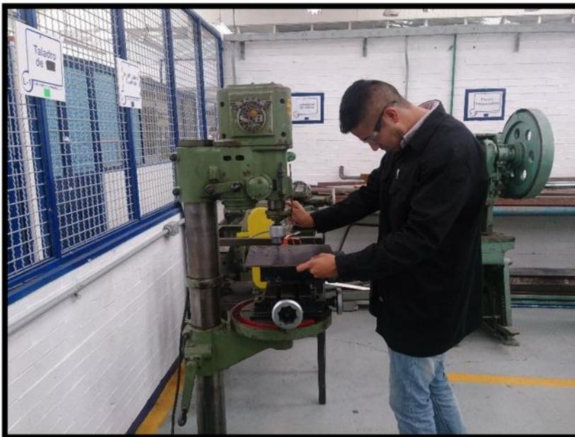
Posteriormente se barrena la placa utilizando un taladro de banco, para los barrenos roscados de 1/4", utiliza una broca de 7/32" y para los barrenos pasados, una broca de 1/4".
