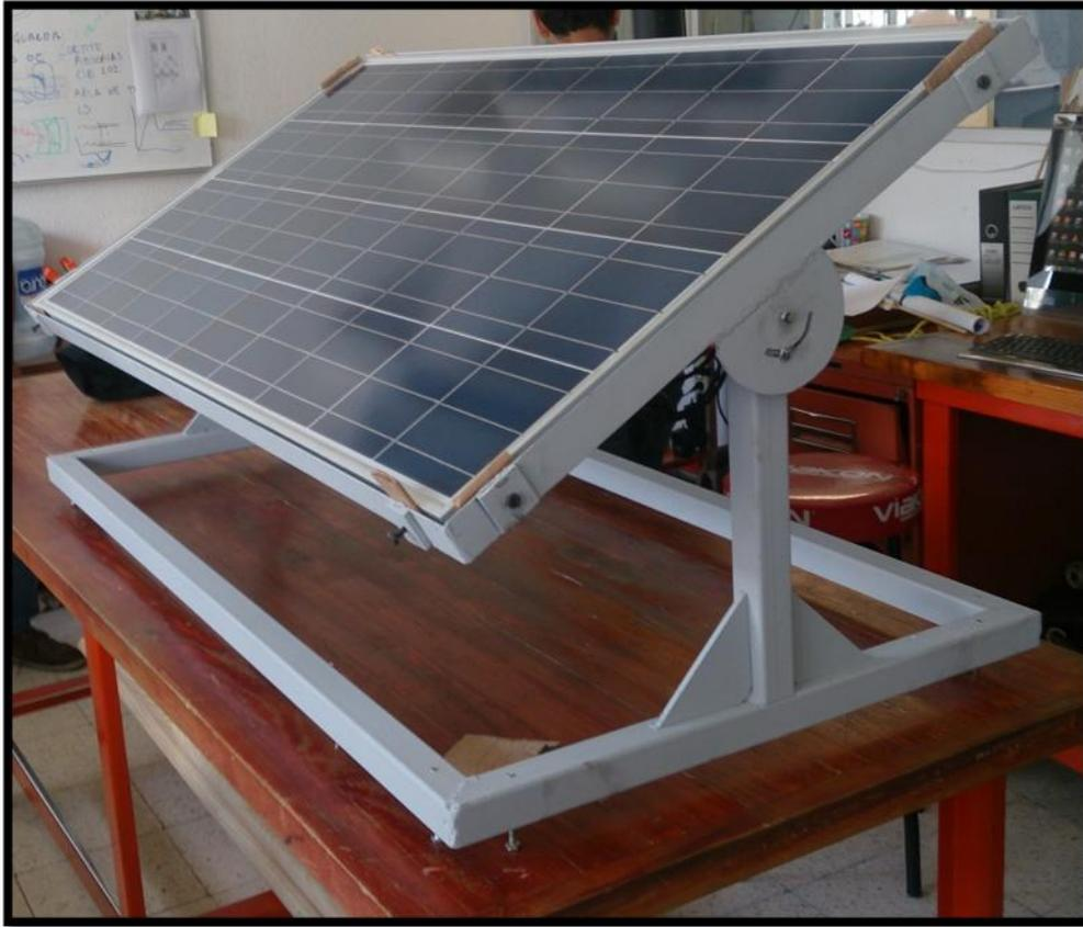
*Figura 5.13 Base graduable para el panel solar.*
