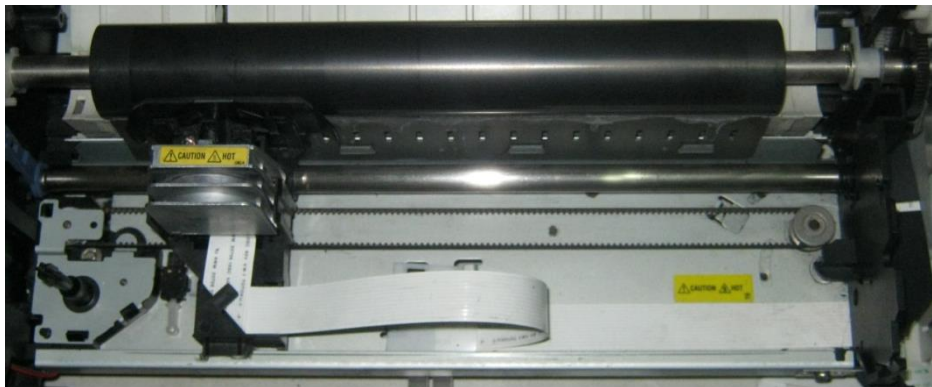
Figura 3.4. Mecanismo de desplazamiento en una impresora.
