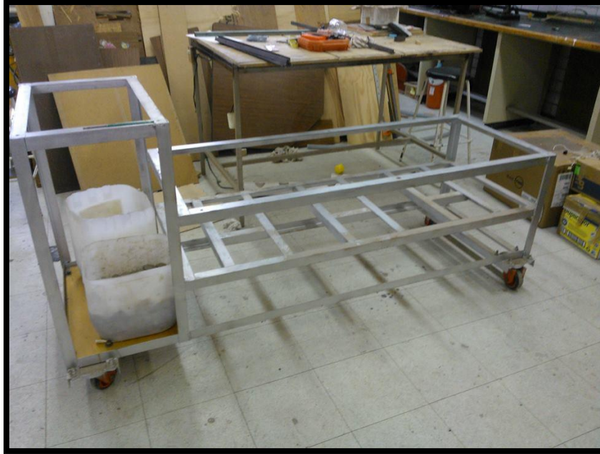
Figura 3.10. Base de metal sobre el cual se construyó el Biodigestor (Falcón y Sánchez, Agosto 2014).
