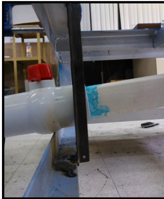
Figura 3.20 Ajuste de barras verticales (Agosto, 2014).
