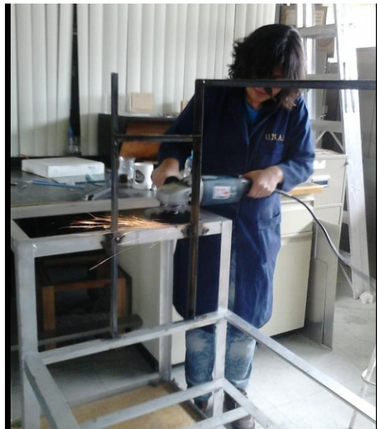
Figura 3.13 Lijado de base de metal (Agosto 2014)
