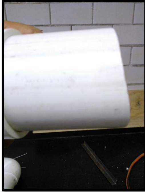
Figura 3.17. Detalle que se realizó a la tubería para obtener la inclinación necesaria para el desalojo de lodos (Agosto, 2014).
