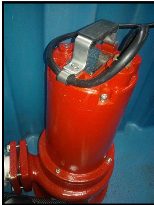
Figura 3.28 Bomba trituradora sumergible. (Octubre, 2014).
