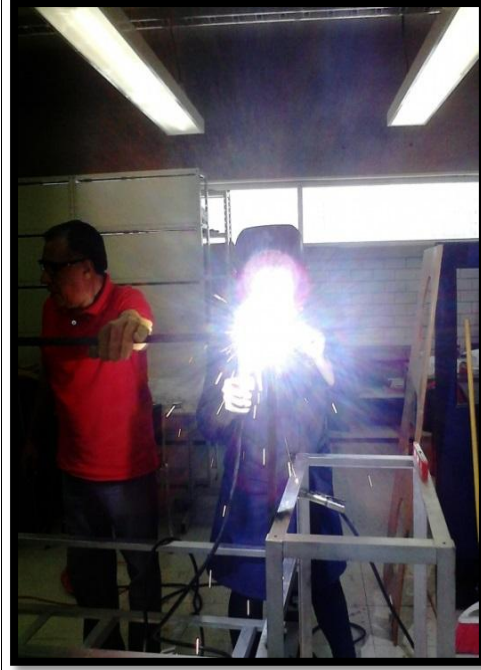
Figuras 3.11 y 3.12. Soldadura a las barras horizontales (Agosto, 2014).
