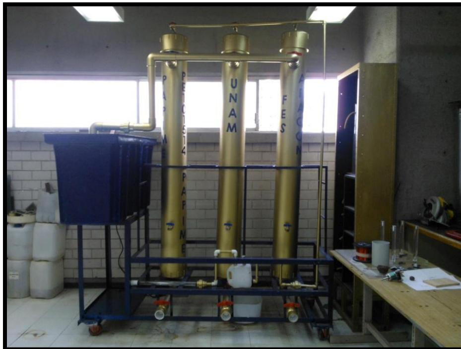
Figuras 3.53 Biodigestor terminado. (Enero 2015).
