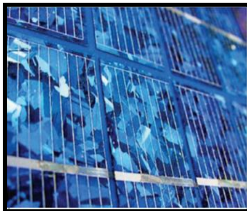
Figura 1.16. Acercamiento frontal de un panel fotovoltaico de Silicio poli cristalino. Se puede observar las diferentes celdas del panel (vetadas en tonos azul) y los contactos eléctricos centrales (líneas plateadas) (Arancibia y Best; 2010).
