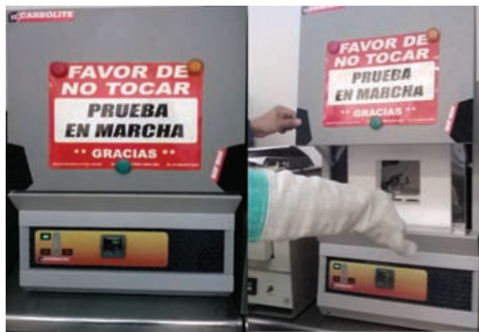
Figura 32. Mufla de resistencias eléctricas y colocación de muestra.
