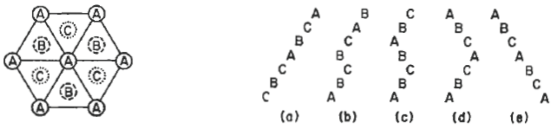
Figura 16. Vista planar de posiciones atómicas y secuencias de apilamiento para: (a)Cristal perfecto Fcc, (b) Falla de apilamiento intrínseca, (c) Falla de apilamiento extrínseca,(d) Falla Macla, (e)Cristal Macla[62] .
