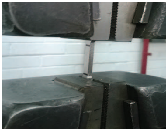
Figura 39. Probeta de tensión sujeta en las mordazas del equipo de tensión.
