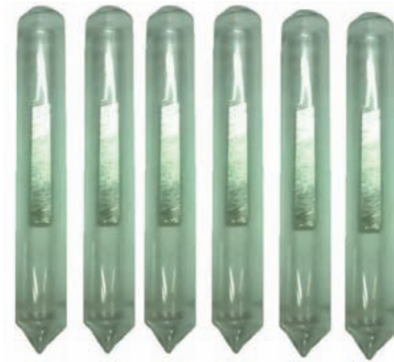
Figura 31. Probetas Co-20%wt.Cr encapsuladas al vacío en cuarzo.
