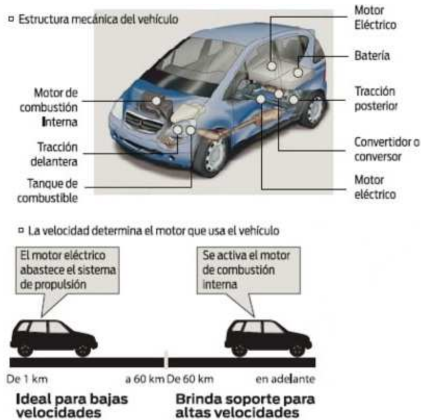
Figura 2.3: Arquitectura de un VHE (infografía publicada en www.taringa.net/Informacion-de-los-vehiculos-Hibridos.html ).
