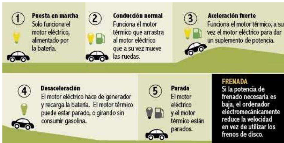
Figura 2.1: Funcionamiento de un VHE (infografía publicada en www.mundoyomotor.com ).
